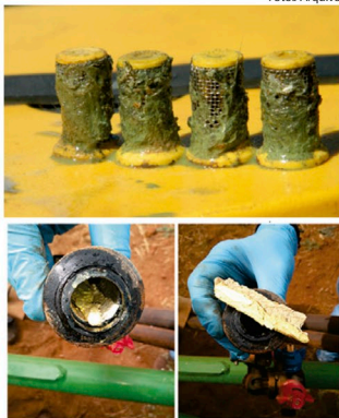
Entupimentos de filtros de pulverizadores com resíduos de produtos aplicados sem uma rigorosa higienização da máquina após o uso
