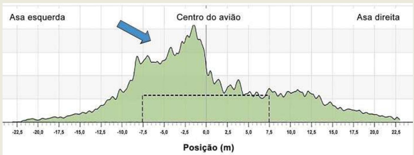
**Figura 6:** Faixa de deposição total, indicada pela imagem verde no gráfico. A linha tracejada indica a largura da faixa efetiva. Neste caso, houve maior deposição das gotas sob a asa esquerda da aeronave, indicado pela seta azul. (Fonte: AgroEfetiva, 2018).
